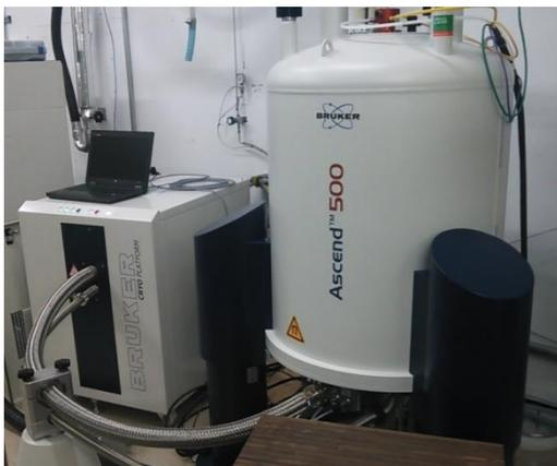
500 MHz + 高感度極低温プローブ (多核対応)
